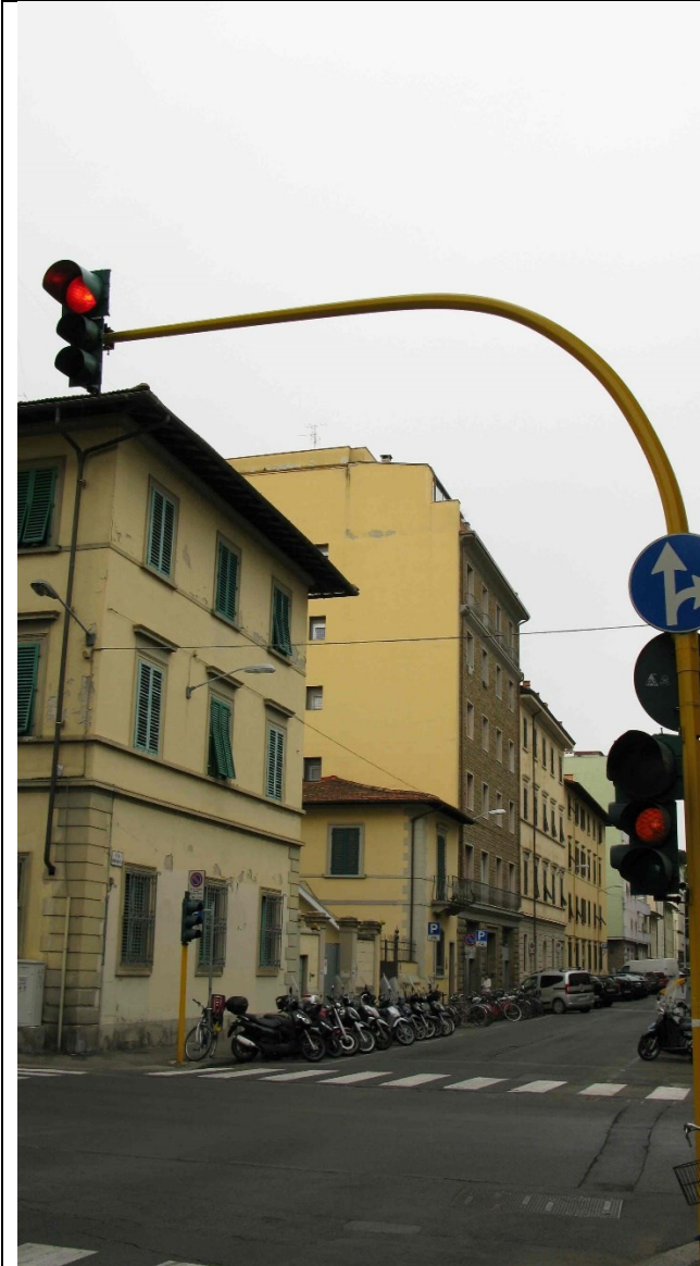
Palo a sbraccio con lanterna semaforica alta
