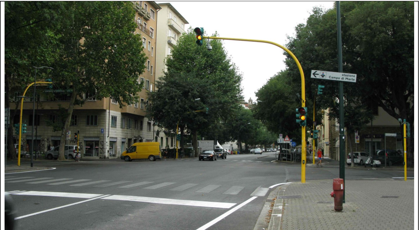
Vista panoramica incrocio tipico con presenza di lanterne semaforiche basse ed alte
