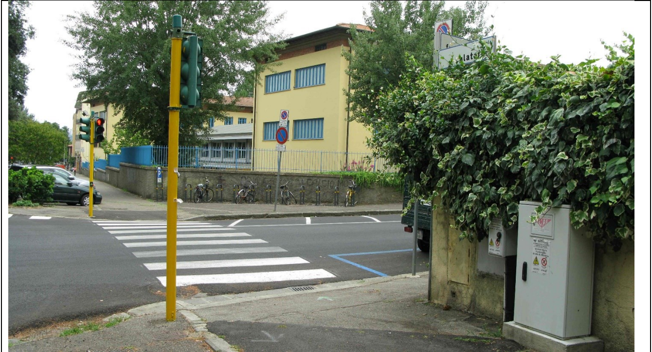
Incrocio con paline semaforiche e centralino semaforico di regolazione
